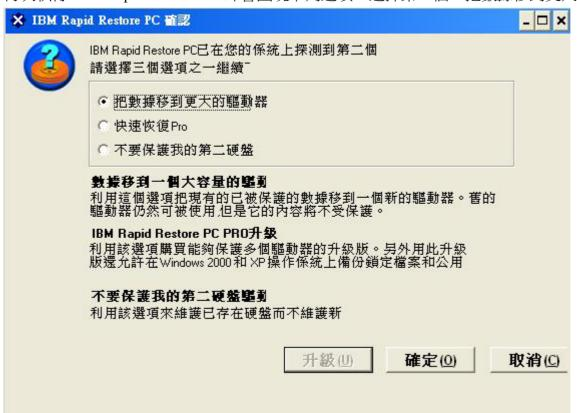
3-2.出現確認事項,要求使用者確認是否將第一硬碟的還原分割區安裝至第二硬碟。 並提示使用者要使用第二硬碟,須將第一硬碟拔除,換上第二硬碟後執行 F11 回復管理程式, 完成還原回復即可開始使用。
