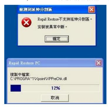
5-3.在做雙硬碟備份時,若出現下列錯誤訊息,表示第二硬碟的容量小於第一硬碟或硬碟故障,請 更換一顆硬碟。
